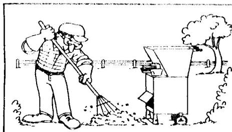
**Očistite ispusni materijal oko stroja pomoću grablji ili nekog drugog alata s dugom ručkom**
