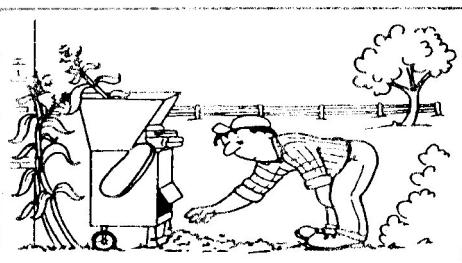
**Ne čistite ispusni otvor rukama. Nikada ne budite u blizini ispusnog otvora**
